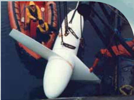
Links und unten: Testversuche mit der ersten Gezeitenturbine der Welt, die von Peter Fraenkel in Loch Linnhe, Schottland, entwickelt wurde. 1994/5 (Fotos: Peter Fraenkel); rechts oben und Mitte: Die Gezeitenturbine SeaGen in Strangford Lough (Fotos: Marine Current Turbine, ein Unternehmen der Siemens-Gruppe)
