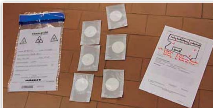
Малюнок 5. Складники мазкової проби радіоактивних матеріалів: поліетиленовий пакет (1, дезактиваційне пакування), пергаментний конверт (2, первинне пакування ) із мазковими пробамі, супровідний документ (3)
