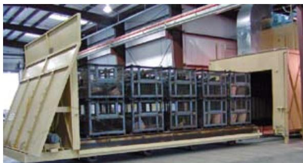
Рисунок 4.5. Установка высокотемпературной газовой дезактивации. На платформу вагонетки погружены металлические короба, содержащие партию прошедших предварительную обработку боеприпасов
