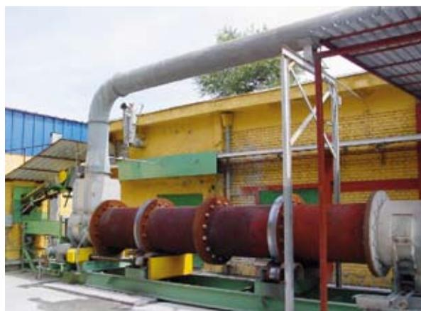
Рисунок 4.1. Внешний вид вращающейся барабанной печи (фото NAMSA)
