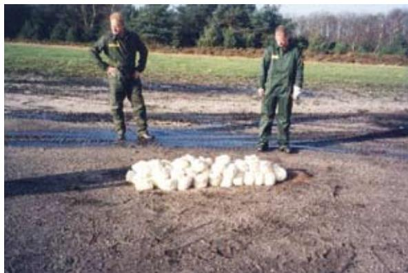
Рисунок 3.2. Готовая к открытому сжиганию партия метательных зарядов в расфасовке
