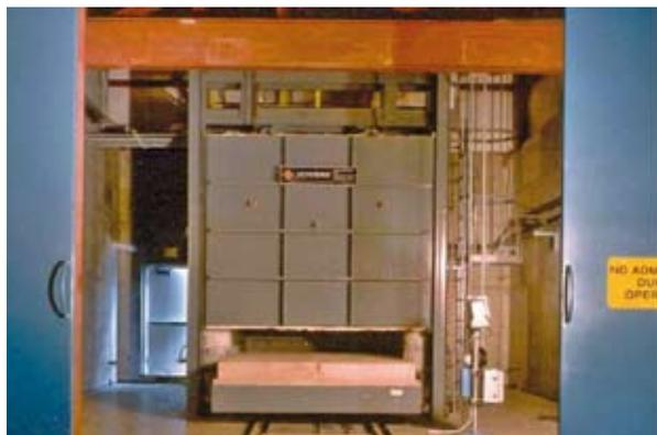
Рисунок 4.4. Вид печи с выдвигаемым поддоном в полукрытом состоянии
