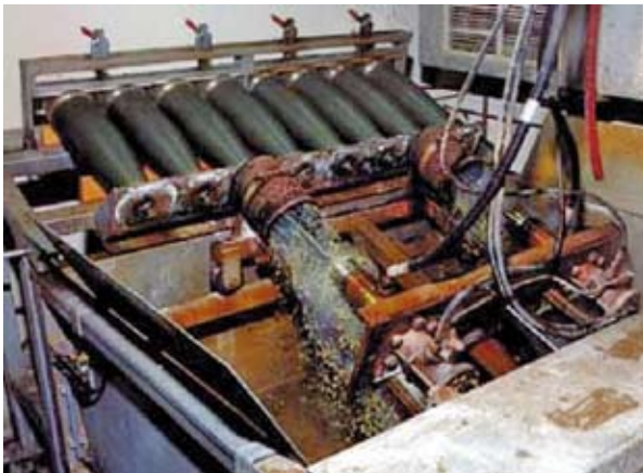
Abbildung 6.3: Auswaschung von 155-mm-Granaten mittels Wasserstrahl
