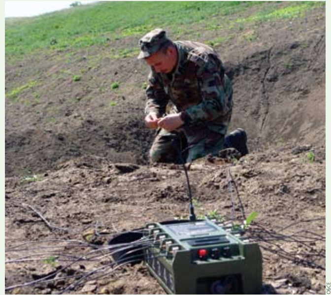
Инженер молдавской армии подготавливает радиоуправляемую систему для дистанционного подрыва взрывчатых веществ
