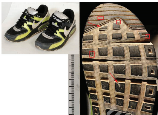
Слика 6. Предметна обућа одузета од осумњиченог лица и газећи профил леве патике са означеним индивидуалним карактеристикама
