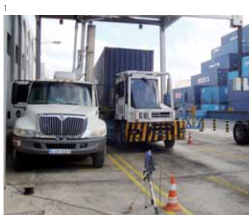
1. Conteneur prêt à être inspecté au moyen d'un scanner mobile à rayons X installé sur un camion, port franc de Malte, 17 décembre 2009. (OSCE/Mehdi Knani) [photo 1 page 17]
